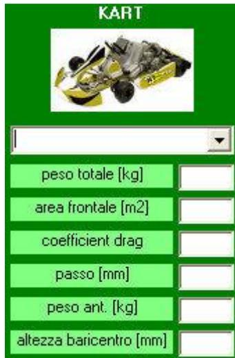
Si devono inserire le caratteristiche principali del kart necessarie per effettuare il calcolo dinamico.
