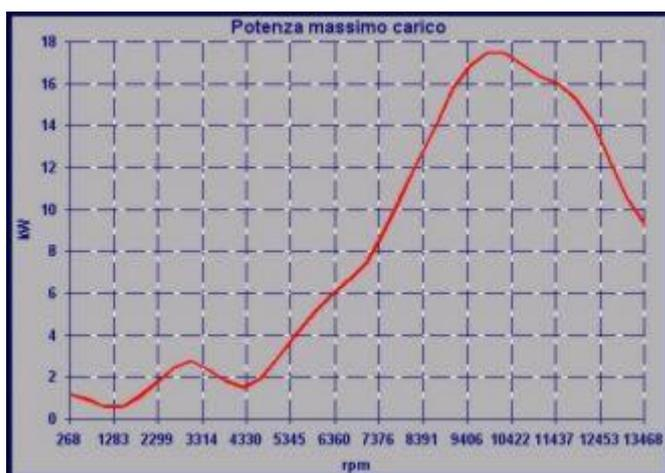
Nelle immagini sopra vediamo le curve prestazionali ottenute dagli stessi dati telemetria delle curve mostrate nella pagina precedente, ma utilizzando lo speciale algoritmo di filtraggio dati del software VIRTUAL DYNO.
