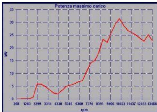
La precisione non ottimale dei sensori delle più comuni telemetrie porta molto sovente ad avere dei risultati irrealistici per le curve prestazionali, infatti con i tradizionali software di telemetria le imprecisioni alterano il calcolo delle prestazioni e si ottengono risultati del tipo di quelli mostrati sopra, quindi forme anomale (immagine a sinistra) o valori di livello molto distanti dal vero (ad esempio i 30 kW dell'immagine a destra lontani dai reali 20 kW misurati al banco)
